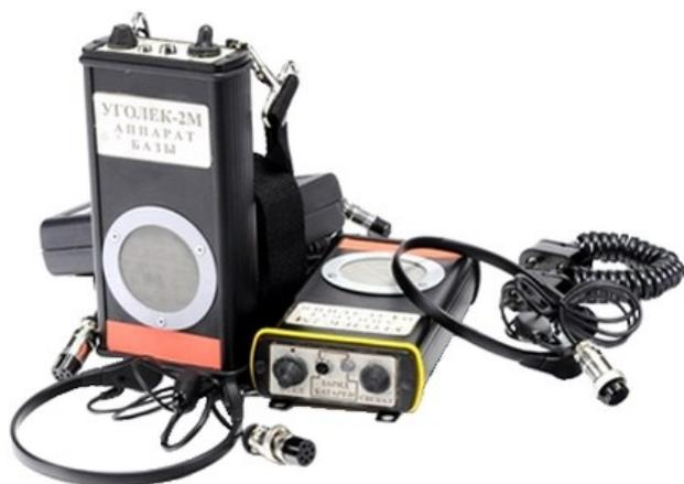
Аппарат проводной связи «УГОЛЕК-2М» предназначен для обеспечения двусторонней симплексной громкоговорящей связи при передаче информации между отделением и базой с одновременным прослушиванием производственных шумов во время движения по горным выработкам. Для обеспечения связи в шахте используется временно проложенная двухпроводная линия.
