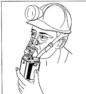
Fig. 8: Si el FSR no pudiera extraerse del envase (caso de que el estuche estuviera muy abollado), el equipo puede utilizarse sin retirar la base del envase, aunque con mayor resistencia a la inhalación.
