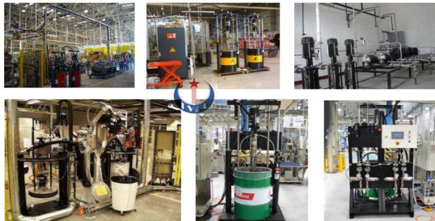
Bơm mỡ vòng bi, trục truyền động/Grease piston pump bearings, drive shafts
