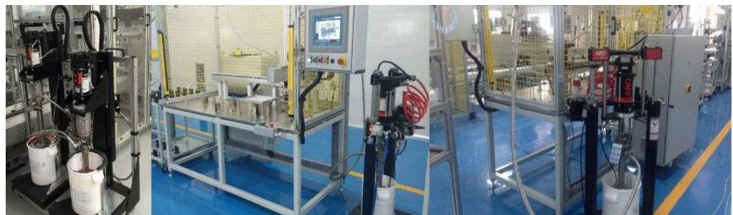
Bơm chất bít kín nắp động cơ/Pump engine cover sealant
